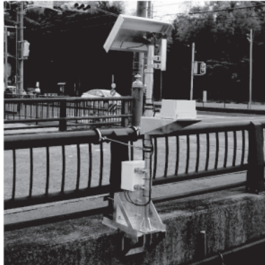
橋梁に設置するタイプ (電波や超音波で河川に 触れずに計測)
